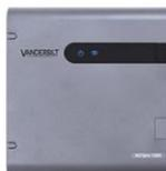
L'ACT PRO 1520 est une unité contrôleur de porte pour 1 porte et extensible jusque 32 portes en boîtier métallique avec une alimentation de 2A et place pour batteries back-up. Dimensions: 255 x 233 x 86mm; pour utilisation en intérieur, poids: 2,450 kg. Contrôle de présence de tension, contrôle de la tension de sortie et du sabotage et notification des messages d'erreur via l'interface Web.
